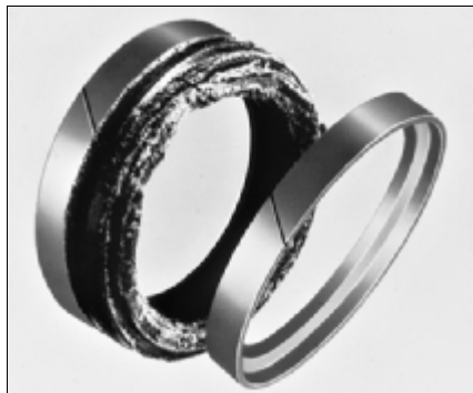
Рис. 4.18 Экструзивный износ компактного поршневого уплотнения
