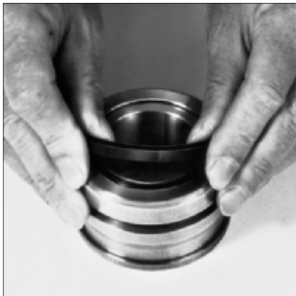
Рис. 4.28 Надевание натяжного кольца
