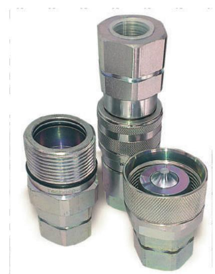
Модифицированный тип ISO A, в котором розетка и ниппель соединяются между собой, вкручиваясь друг в друга. Характеризуется безотказным резьбовым соединением и имеет преимущество перед БРС типа FIRG
